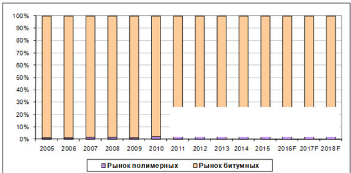
Рисунок 62. Прогноз количественного соотношения сегментов традиционных (битумных и битумно-полимерных) рулонных материалов и полимерных мембран на российском рынке до 2018 г., %.
